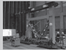
右上/鉄骨ブレースによる耐震 補強後の性能を確認する実験 右中/鉄骨構造の部材の地震時 破壊挙動を再現する実験
