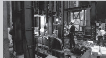
右上/鉄骨ブレースによる耐震 補強後の性能を確認する実験 右中/鉄骨構造の部材の地震時 破壊挙動を再現する実験
