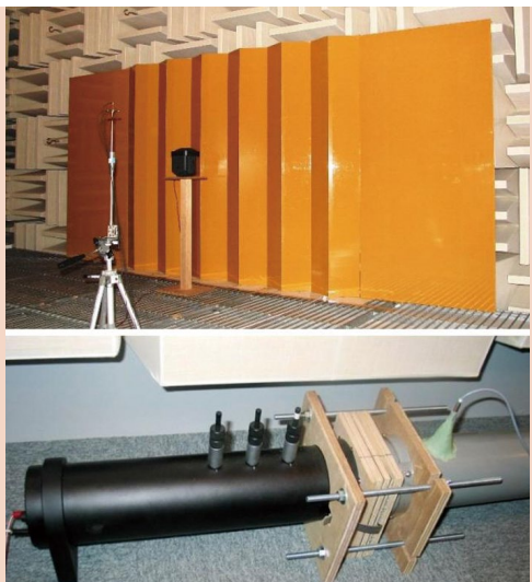
【右写真】 拡散性反射面による音響反射特性に関する無響室内の測定（上） 新しい遮音構造体の開発に関する音響管を使用した実験（下）
