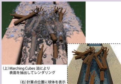
【左図】 橋梁の流木閉塞過程の数値シミュレーション
