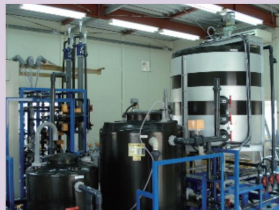
【左写真】下水再利用を目的とした膜処理パイロットプラント装置
