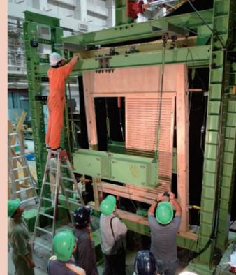
**【左写真】 伝統構法による木造建物の耐震性能実験**
