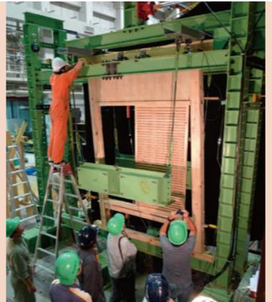
【左写真】伝統構法による木造建物の耐震性能実験
