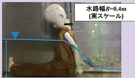
**【左図】側溝内での人体による水深せき上げ**
