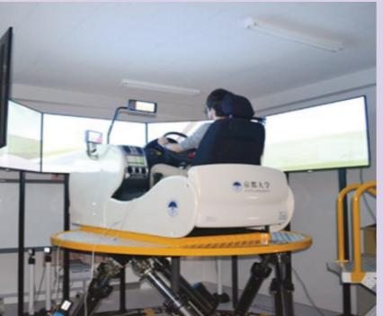
**【左写真】ドライビングシミュレータによる模擬運転実験**
