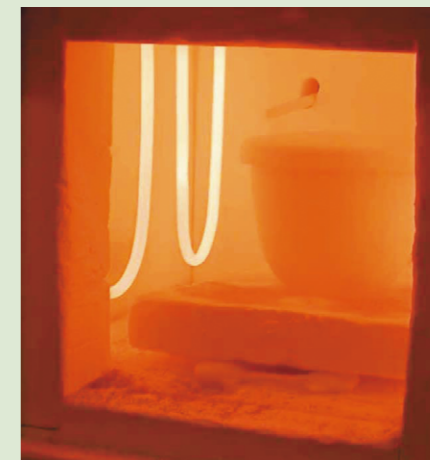
【左写真】 1000℃以上の高温における機能性セラミックスの合成
