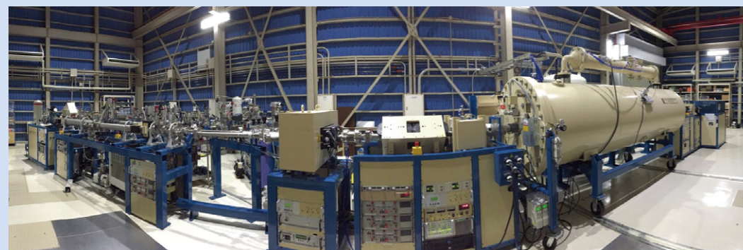
MeV イオン加速器とビームライン 放射実験室に設置されている4台の静電加速器のうちの1台。水素やヘリウム、炭素、シリコンなどの様々なイオンを高速度に加速して真空中の原子や分子、液体、固体などに当てる装置。この方法で量子力学的なミクロの世界を直接眺めることができます。
