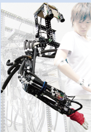
【左図】人間の筋骨格構造を模倣したヒューマノイドロボット
