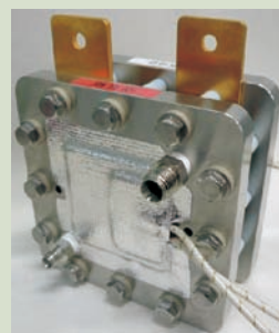
【左図】固体高分子型燃料電池（PEFC）の概念図 【右写真】固体高分子型燃料電池（PEFC）の単セル 固体高分子型燃料電池（PEFC）のさらなる性能の向上を可能にするため、PEFC全体を記述する工学モデルの開発を進めています。
