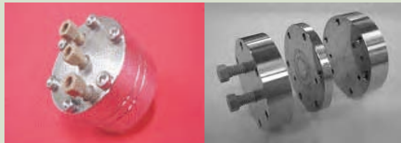
【上写真】直径5cmのマイクロ反応器（右は分解図）
