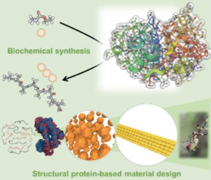
【左図】アミノ酸や糖などの生体分子を、生物触媒により重合することで、合成高分子では発現できない機能および物性を示すバイオ高分子を創出する。自然界に存在する構造タンパク質を理解・模倣することで、次世代バイオ高分子材料を開発・実用化する。
