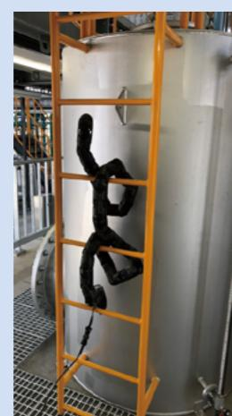
**[左写真]** 災害現場での情報収集やプランターの点検を行うヘビ型ロボット
