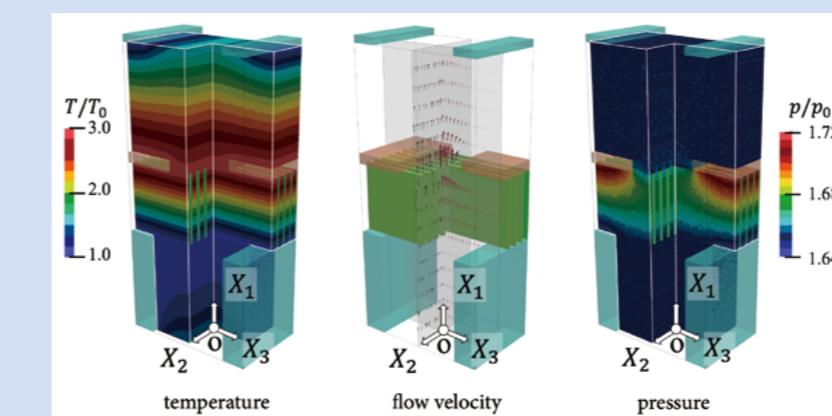
低圧気体やマイクロ流体では、日常の経験に基づく常識に従わない現象も多い。図は、温度差をエネルギー源とする気体の流れや混合気体分離装置への応用。
