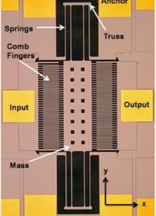
**微小電子機械（MEMS）共振器**
