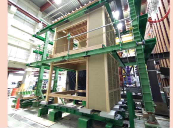
【右写真】鉄塔嵩上げ構法の力学性能を確認する載荷実験
