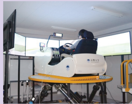
【左写真】ドライビングシミュレータによる模擬運転実験 加減速度を体感可能な6軸モーション装置を持つドライビングシミュレータを導入し、模擬走行実験を行っている。安全運転支援情報の効果分析、地震時の停車行動の分析、自動運転時のマニュアル運転リクエストの影響分析等の研究課題に活用している。
