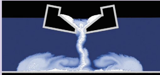
【左図】高波による潜堤の被災シミュレーション 海岸景観に配慮した水没型の防波堤である潜堤は、捨石を積み上げたマウンドとコンクリートブロックから構成される。左図は、高波が砕波して生じる流れによる潜堤の崩壊過程を再現した数値シミュレーションの結果である。
