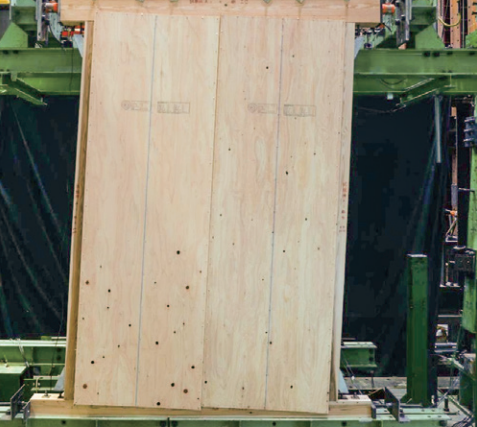
【左写真】木造住宅の変形・抵抗力・壊れ方を調べる試験 木造住宅の一部分を模した試験体に力を加えることで、微小変形から大変形に至るまでに生じる変形・抵抗力や壊れ方を調べる。
