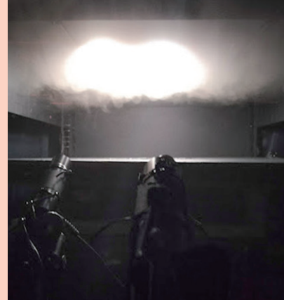
【左写真】火災時における煙層内での散乱光測定
