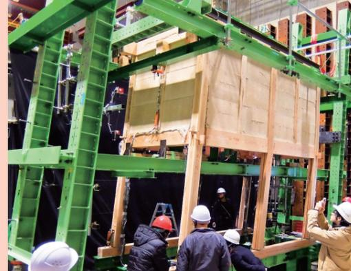
**【左写真】 伝統構法による木造建物の耐震性能実験**
