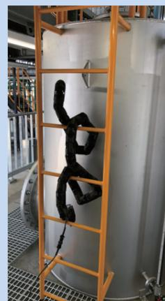
【左写真】 災害現場での情報収集やプラントの点検を行うヘビ型ロボット
