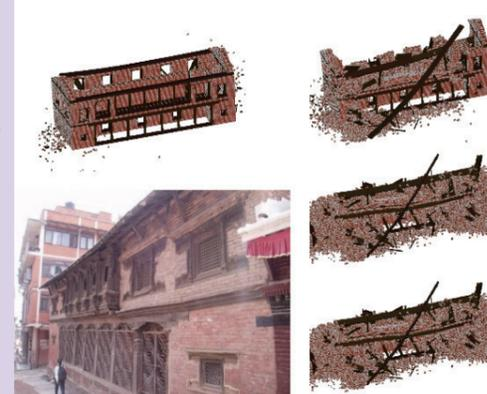
【右図】組構造の崩壊解析
