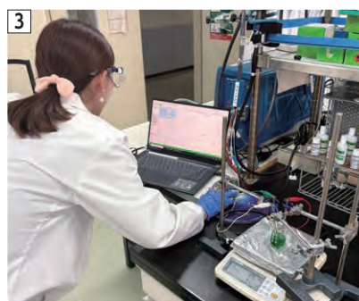
1. セメント中の[100]刃状転位の原子分解能走査透過電子顕微鏡像 2. 高Mn鋼における局所変形帯の生成・伝播・消滅 3. 新しくデザインした電解液からの金属電析実験 4. 超高速・大規模数値計算が可能な材料設計のためのスーパーコンピュータ
