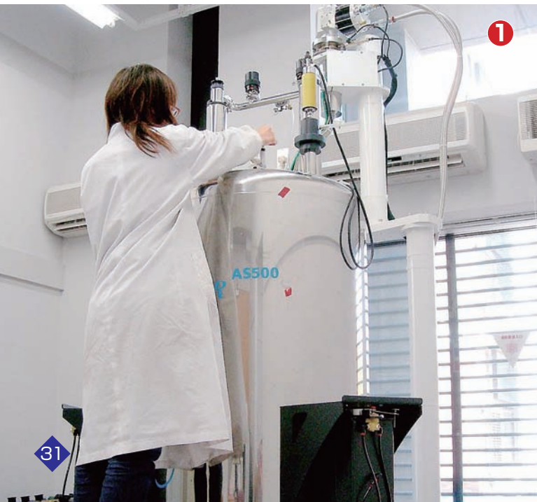
① 有機化合物の構造研究に用いる 400MHz 核磁気共鳴装置。液体ヘリウムにより冷却された超伝導マグネット中で測定し、ごく微量の有機化合物の試料で立体化学を含めた構造が決定できる。
