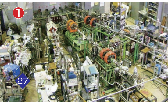
① バンデグラフ型重イオン加速器から伸びる真空のビームライン：高速イオンを用いた原子レベルでの観測が行われる
