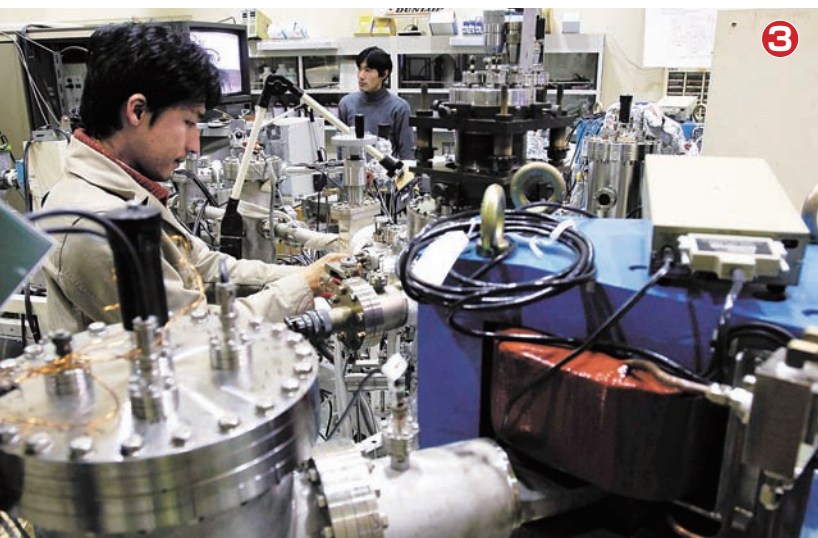
③ 原子レベルの分解能で材料を分析することができる高分解能イオン散乱分光装置
