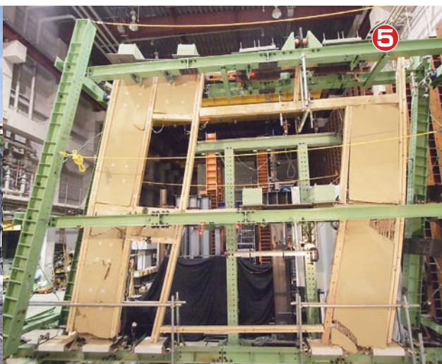
5 2層京町家試験体の静的加力実験
