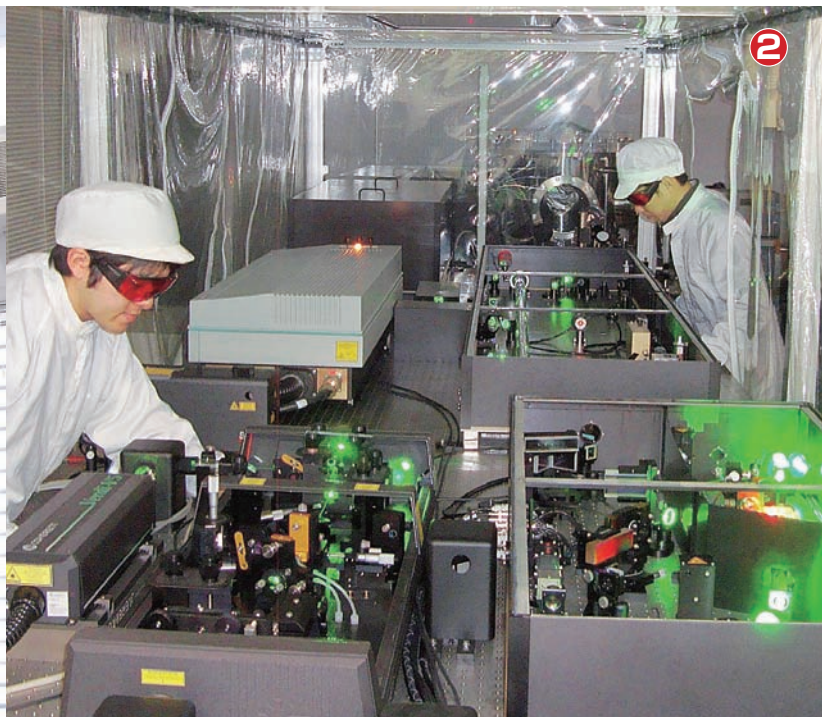
② 物質と光との相互作用に関する研究に用いる超短パルスレーザー光源。チャープパルス増幅(CPA)によりフェムト秒オーダー( 10^{-15} 秒)にパルス圧縮されたレーザー光が発振されている。超高強度光電場を利用した様々な材料の表面や内部の局所構造改質により、新しい機能を発現させることができる。
