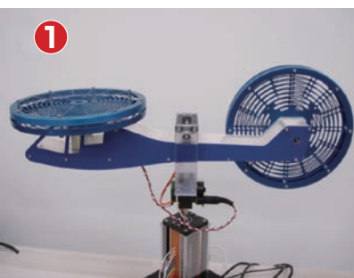
① ヘリコプタ姿勢制御実験装置。デジタル制御により高度な制御性能を達成するための理論的・実験的研究の一例。
