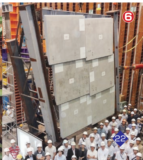
6 カーテンウォールの脱落限界検証実験
