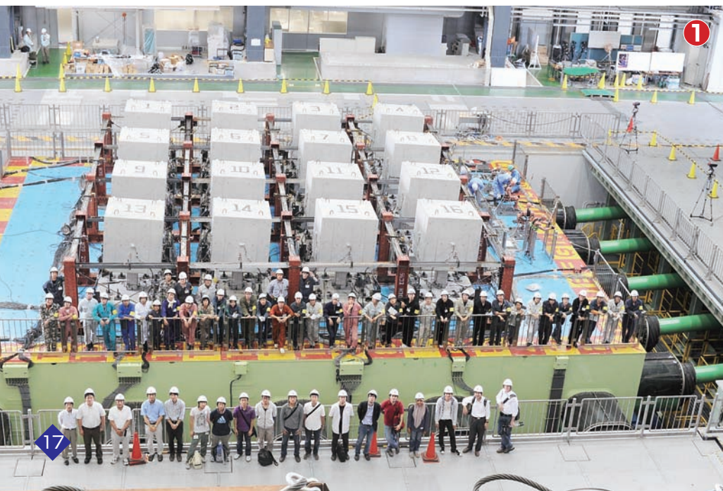
① 大規模振動台によるコンクリート構造物の損傷評価実験
