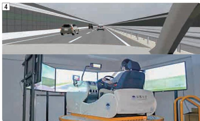
1. 風洞実験施設 2. 粒子法による水理シミュレーション[(左) 砕波現象;(右) 流木閉塞による小河川の氾濫] 3. Eco-DRRのためのフィールド調査(西表島におけるマングローブ樹林調査) 4. 6軸モーションを装備したドライビングシミュレータ(下)とドライビングシミュレータのVR空間のイメージ(上)
