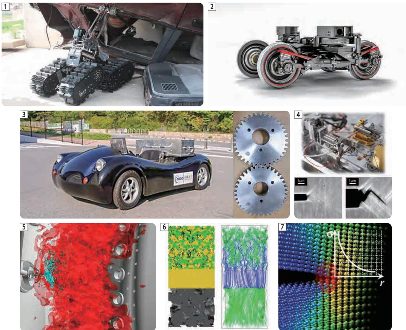
1. レスキューロボット 2. 炭素繊維強化樹脂(CFRP)を用いた鉄道車両台車 3. 駆動力抜けのない変速システムを搭載した電気自動車と変速システム用非円形歯車の例 4. 微小機械の破壊に関するその場観察実験 5. 航空機用ガスタービンエンジン内の乱流噴霧燃焼のコンピュータ・シミュレーション 6. 燃料電池の局所構造と電子/イオン電流シミュレーション 7. 構造材料の変形・破壊の原子/電子レベル・シミュレーション
