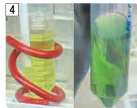
1. イオンビームを発生させる加速器。ビームをマイクロメートルの大きさにして物質の微細領域の組成分析ができる。 2. ヘリカル型核融合装置におけるプラズマ中で高速イオンが中性化し、脱励起する際に放出する光のシミュレーション。 3. カブトムシの中性子透過写真。体内でも水分の多い部分が黒く映りやすい。 4. ウラン(VI) (左) およびウラン(IV) (右) の水溶液。
