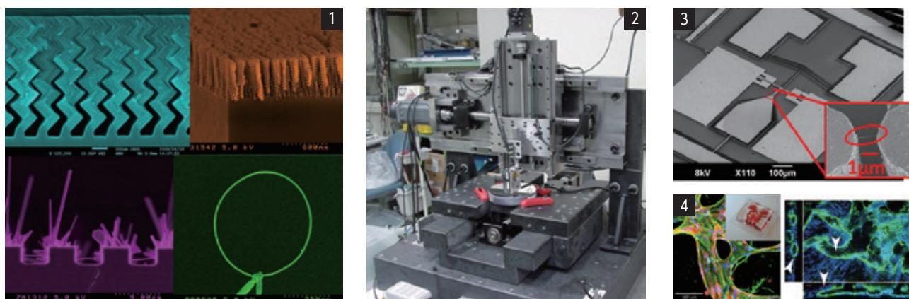
① 斜め蒸着法によるナノ形態の制御例 ② 様々な位置決め技術の試験のために設計・製作した高精密工作機械の試作機 ③ 単層カーボンナノチューブの強度と疲労メカニズムの解明用MEMSデバイス ④ マイクロ流体デバイスとその内部に再構成した血管網
