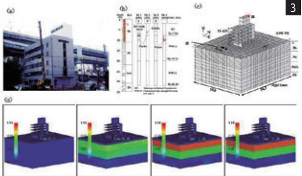
1 風洞実験施設 2 粒子法による水理シミュレーション〔(左) 破波現象: (右) 流木閉塞による小河川の氾濫〕 3 杭基礎構造物の地震時挙動に関する3次元解析
