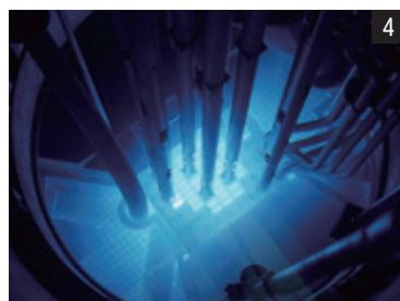
① イオンを光速の1/10~1/100程度に加速する装置。原子や核の衝突反応、原子レベルの物質分析等に用いる。 ② イオンビーム複合分析装置。微量元素分析や組成分析、構造解析、材料照射を行う。 ③ ヘリカル型プラズマ閉じ込め装置の磁場配位とそこに閉じ込めた高エネルギー粒子の軌道解析 ④ チェレニコフ光：荷電粒子が物質中を高速で走るときに放出する光であり実験原子炉内でもみられます。
