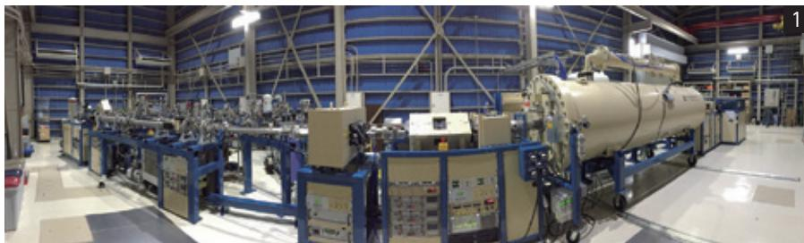
① 様々なイオンを高速度に加速して真空中の原子や分子、液体、固体などに当てる装置。量子力学的なミクロの世界を直接眺めることができる。
