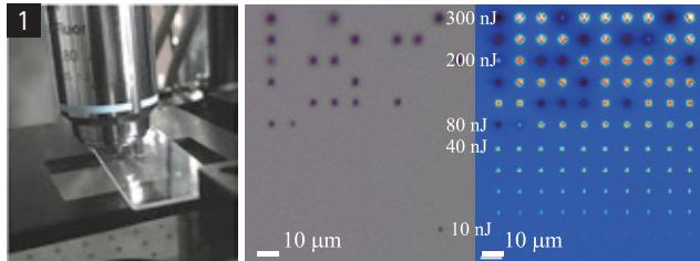
1 パルス幅40fsのレーザー光をダイヤモンド内部に集光照射するとグラファイト化や欠陥構造が局所的に光誘起される。グラファイト化は導体として、欠陥構造は量子ビットとして機能する。（左側：レーザー照射中の様子、中央：光学顕微鏡像、右側：蛍光顕微鏡像） 2  $\text{Na}_2\text{SiO}_3$ ガラスの分子動力学計算モデル。2500Kから300Kへ30psかけて冷却した。 3  $\text{CO}_2$ レーザーを用いたガス浮遊レーザー溶融炉。無容器法による不均一核生成を抑制することで本来ガラス化しない組成のガラスの作製が可能。
