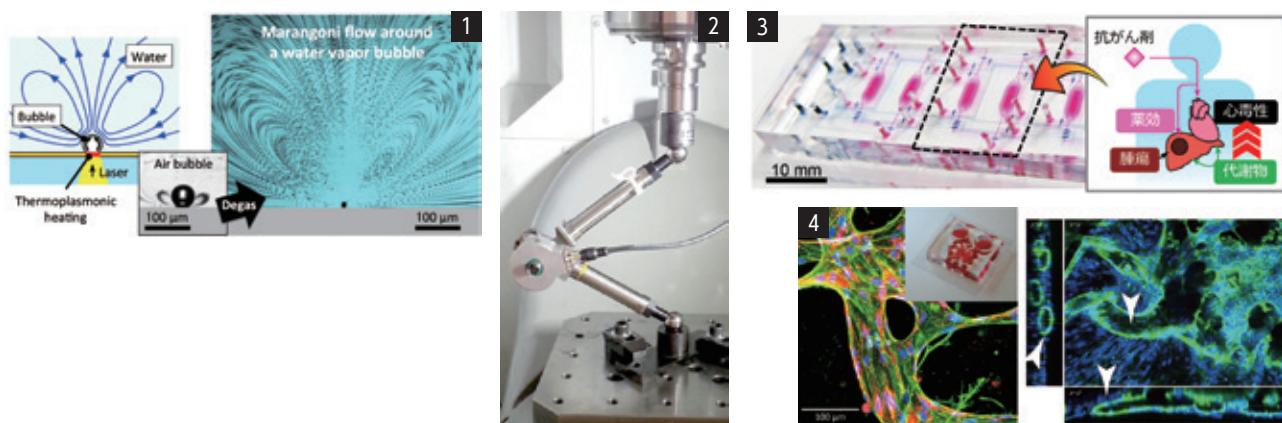
① 水蒸気バブルを使ったマイクロミキサー ② 3次元空間での工作機械の運動誤差測定のために開発した測定器 ③ ヒトや実験動物を用いることなく抗がん剤の副作用を生体外で再現するデバイス「ボディ・オン・チップ」 ④ マイクロ流体デバイスとその内部に再構成した血管網
