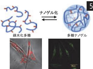
1 ホウ素含有共役系高分子による発光材料の一例。ヘテロ元素の特性を利用するとユニークな光・電気特性や刺激応答性を示す材料が得られ、新規の有機デバイス・センサー開発への応用が期待できる。 2 精密重合の進歩により、高分子鎖の長さ（分子量）や末端基の制御のみならず、モノマーの並び方（配列）制御や、環状鎖に代表される鎖形態の制御が可能になる。 3 高分子太陽電池などの光・電子機能材料の中で起こる電子などの移動現象を、超高速レーザ分光測定により分子の時間スケールで直接観測する。 4 両末端会合性高分子が形成する花形ミセルの計算機シミュレーションにより得られたスナップショット。この高分子は、溶液の粘弾性的性質を劇的に変化させることができる。 5 会合性分子の導入により水溶性高分子の自己組織化を制御することでナノゲルが得られる。このナノゲルを利用して細胞にタンパク質をデリバリーする。
