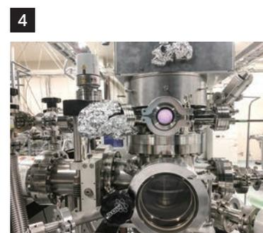
1 円柱前方に形成された強い衝撃波による空気力学的加熱に対する亜音速逆方向ジェットによる冷却 2 未知環境下での探査ローバーの制御実験 3 航空宇宙機の構造に用いられる繊維強化複合材料の異方性弾性特性（超音波による測定結果）(a) 一方向積層材, (b) 直交積層材 4 静電加速型電気推進の実験装置（誘導結合プラズマ源の放電の様子）
