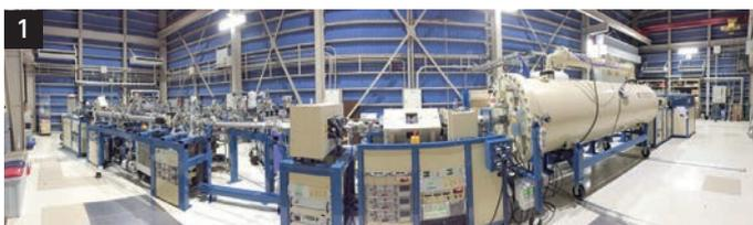
**1** イオンビームを発生させる加速器。ビームをマイクロメートルの大きさにして物質の微細領域の組成分析ができる。**2** ヘルカル型核融合装置におけるプラズマ中で高速イオンが中性化し、脱励起する際に放出する光のシミュレーション。**3** カプトムシの中性子透過写真。体内でも水分の多い部分が黒く映りやすい。**4** FFAGシンクロトロン：陽子ビームを150 MeVまで加速。高繰り返し・短パルス(30 Hz・100 ns)ビームの特徴を生かし、原子核物理・医療等の実験に利用。
