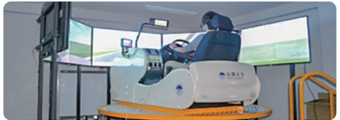
1. 風洞実験施設 2. 粒子法による水理シミュレーション[(左) 砕波現象;(右) 流木閉塞による小河川の氾濫] 3. Eco-DRRのためのフィールド調査(西表島におけるマングローブ樹林調査) 4. 6軸モーションを装備したドライビングシミュレータ(下)とドライビングシミュレータのVR空間のイメージ(上)
