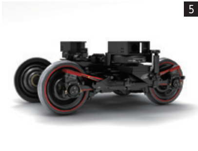
1 最先端の機械工学の成果を用いて開発が進められている磁気浮上式鉄道 2 微小材料の変形・破壊に関するその場観察実験と原子シミュレーション 3 レスキューロボット 4 身体運動の観察時系列データからの運動状態・行動意図の推定 5 2014年から運用が始まった、CFRP（炭素繊維強化樹脂）を用いた鉄道車両用台車 6 駆動力抜けのない変速システムを搭載した電気自動車と変速システム用非円形歯車の例 7 ビタミンE添加ポリエチレンを用いることにより、耐久性を高めた人工膝関節
