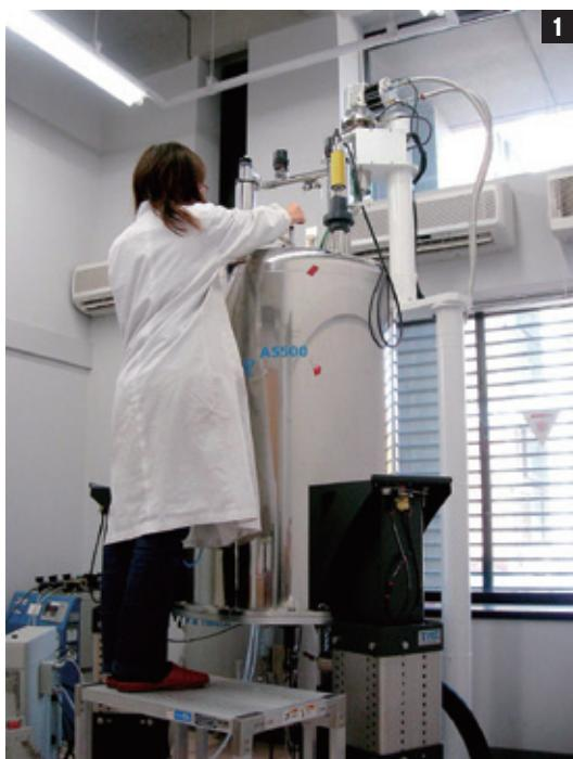
① 有機化合物の構造研究に用いる400MHz 核磁気共鳴装置。液体ヘリウムにより冷却された超伝導マグネット中で測定し、ごく微量の有機化合物の試料で立体化学を含めた構造が決定できる。② 物質と光との相互作用に関する研究に用いる超短パルスレーザー光源。チャーブパルス増幅（CPA）によりフェムト秒オーダー ( $\sim 10^{-15}$ 秒) にパルス圧縮されたレーザー光が発振されている。超高強度光電場を利用した様々な材料の表面や内部の局所構造改質により、新しい機能を発現させることができる。
