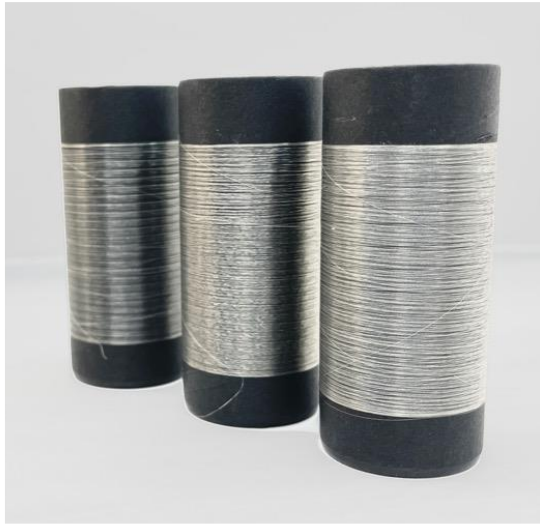
図4 | 紅色光合成細菌由来タンパク質を用いて紡糸した繊維
