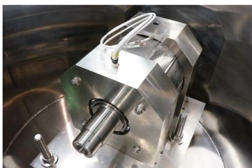
図1：20 kW級高温超伝導誘導同期モータの外観写真 [6]
