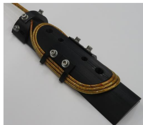
曲げ半径 25 ミリメートルで 3 巻きした立体 形状の鞍型コイル（写真提供：京都大学）
