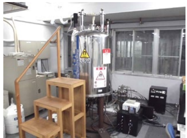
高感度プローブがついた NMR 装置 (ECZ600RJEOL 製)
